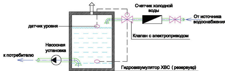
Схема аккумуляции горячей воды
